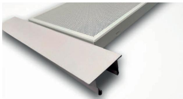
Bandejas prelacadas en Poliéster con un espesor de capa de mínimo 25 micras en color Blanco (RAL 9010) o Silver (RAL 9006). Este tipo de acabado se caracteriza por una alta resistencia a la corrosión y durabilidad (retención de brillo y color).
