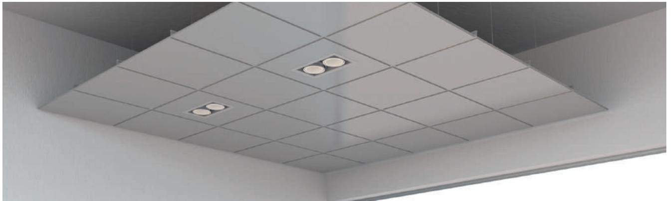
Bandejas conformadas por plegado, fabricadas con chapa de acero galvanizado prelacado de 0,50 mm de espesor. Existe la opción de fabricar las bandejas en aluminio de 0,60 mm de espesor.
