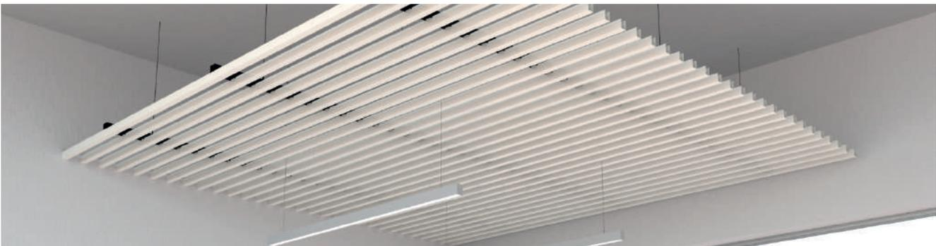
Lamas fabricadas con aluminio prelacado de 0,45 mm de espesor más recubrimientos conformadas por laminación en frío. Lamas prelacadas en Poliéster con un espesor de capa de 20 micras en ambas caras en color Blanco, Negro (RAL 9005), Silver (RAL 9006). El rastrel de las lamas Italia 30 va prelacado en Negro.
