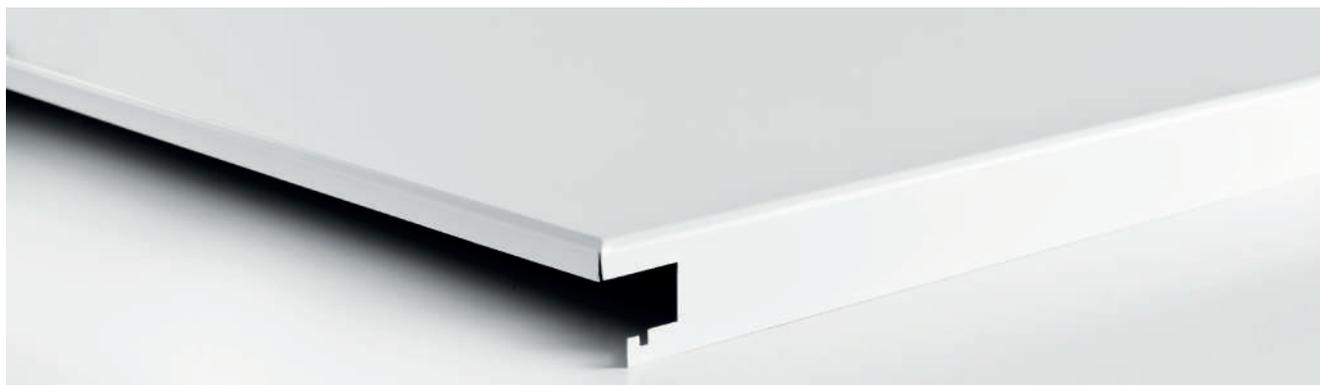
Bandejas conformadas por perfilado y/o plegado, fabricadas con chapa de acero prelacado de 0,50 mm de espesor. Prelacadas en Poliéster con un espesor de capa mínimo de 25 micras en color Blanco (RAL 9010) o Silver (RAL 9006).
