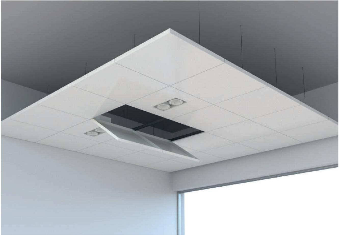
El modelo **Sicilia Clip-in abatible** supone un paso más respecto al modelo Sicilia clip-in tradicional. En formatos de 600x600 mm y 300x1200 mm, su diseño **permite hacer registros continuos sin tener que extraer la placa íntegramente del perfil**. La placa en ambas dimensiones, quedaría colgada y actuaría como una trampilla tradicional de registro con la comodidad que esto supone para el personal de mantenimiento.
