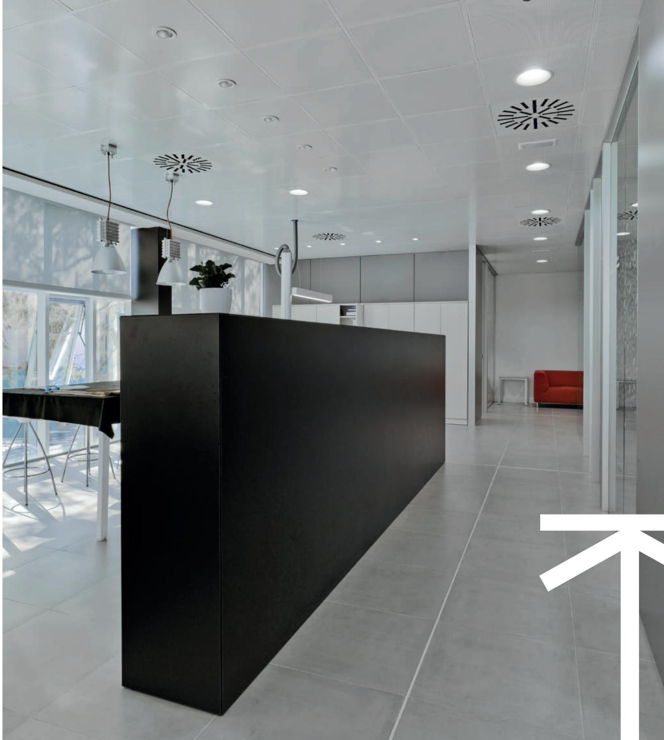
El sistema **MÓDENA T24** ofrece una estructura registrable de techo metálico en formatos de 600x600 mm y 300x1200 mm apoyada sobre perfiles T24, T-Dekor 24 y T-Clip 24.
