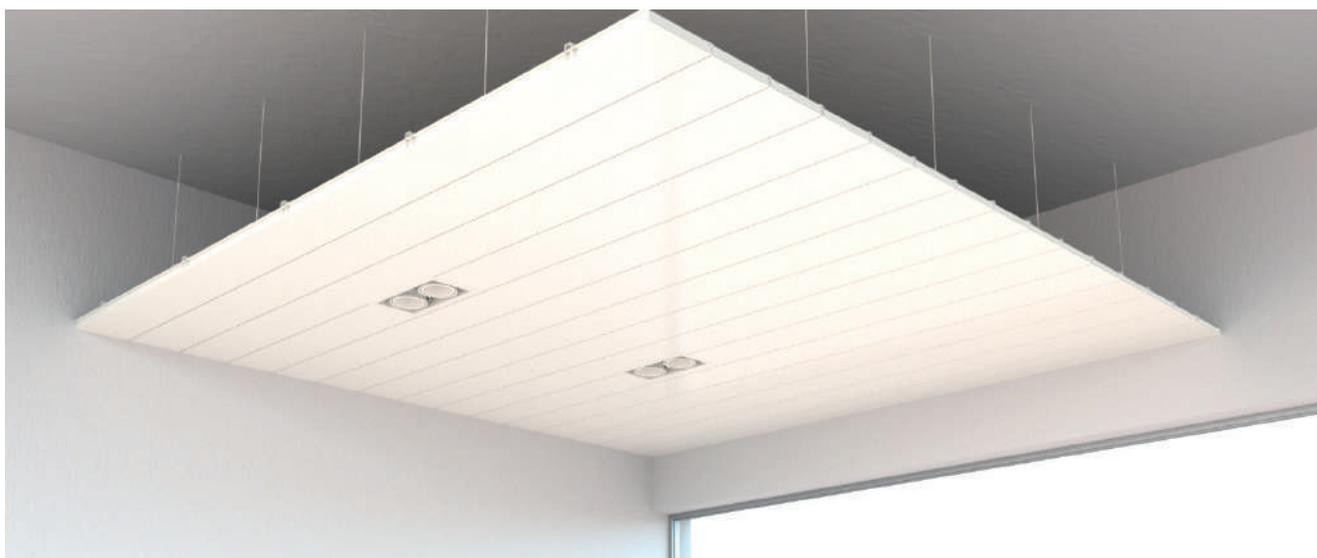
Lamas conformadas por perfilado y plegado, fabricadas con chapa de acero galvanizado prelacado de 0,50 mm de espesor o aluminio prelacado de 0,50 mm (200 Lisa) o 0,60 mm (300) suministrado con film adhesivo de protección.
