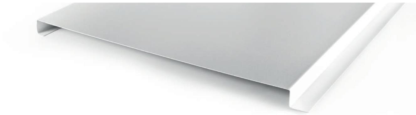
Lamas fabricadas con aluminio prelacado de 0,45 mm (0,55 mm en Treviso 200 y 300) de espesor más recubrimientos conformadas por laminación en frío.
