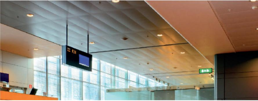
Las laminas Tívoli son una evolución de las laminas Teramo. Están especialmente reforzadas para tener una base más ancha de 300 mm sin abultamiento. Las laminas Tívoli pueden equiparse con sistemas de bloqueo, adecuados para gimnasios o estaciones de tren.
